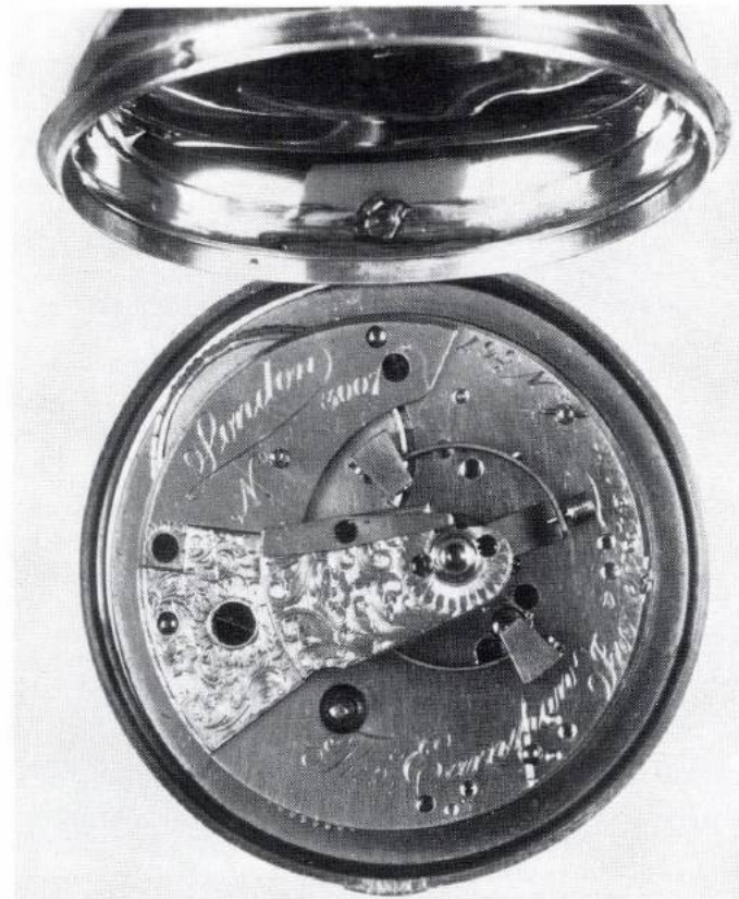
5 Taschenuhr mit Goldgehäuse von Thomas Earnshaw mit Chronometerhemmung, bei der die Chronometerfeder auf »Druck« belastet wird. Der bimetallische Unruhreif hat Wendelfeder und wird an den Gewichtsschrauben reguliert
