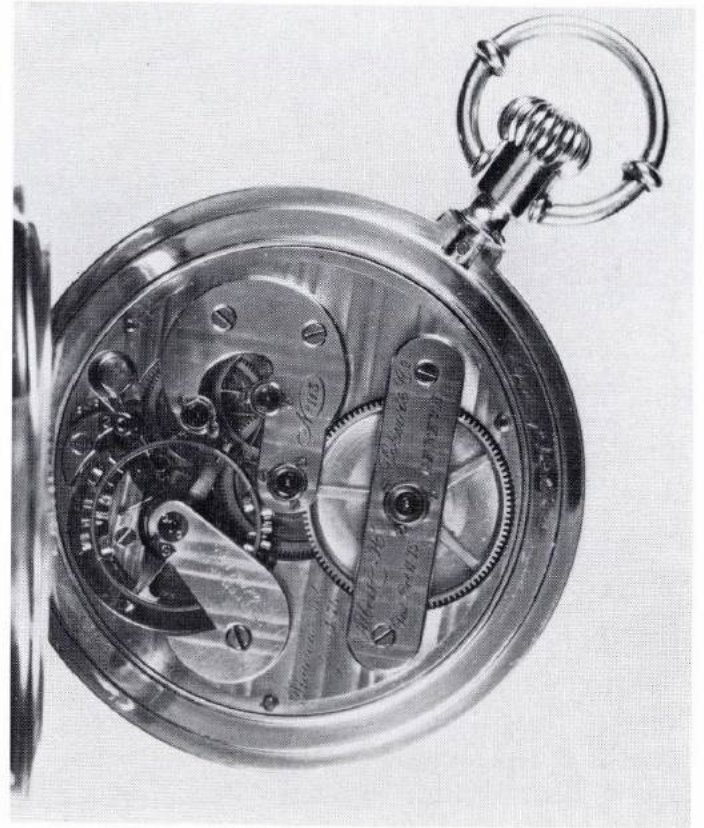
25 Werk von Abb. 24. Die Klobenformen und die außergewöhnlich präzise Wippe zeigen die sensible Ästhetik von Albert Potter
